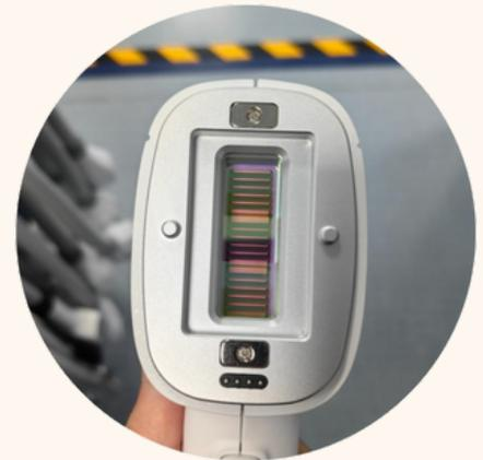
**L'augmentation significative de la puissance, l'application du système FAC et la configuration en double rangée des barres permettent à l'énergie laser de sortie d'être plus concentrée, plus uniforme et de pénétrer plus profondément, ce qui rend le traitement plus efficace.**
